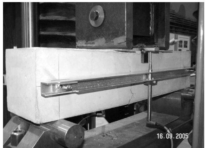
Bild 3. Biegezugversuch mit Vierpunktbelastung
